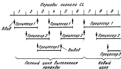
Рис. 4.43. Временная диаграмма работы системы (рис. 4.40) при выполнении простой команды. Команда содержит пять заданий, каждое из которых выполняется за два периода сигнала CL. В работе участвуют три процессора из пяти
